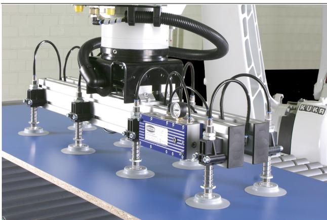
Esempio di montaggio aste a molla FSTF
